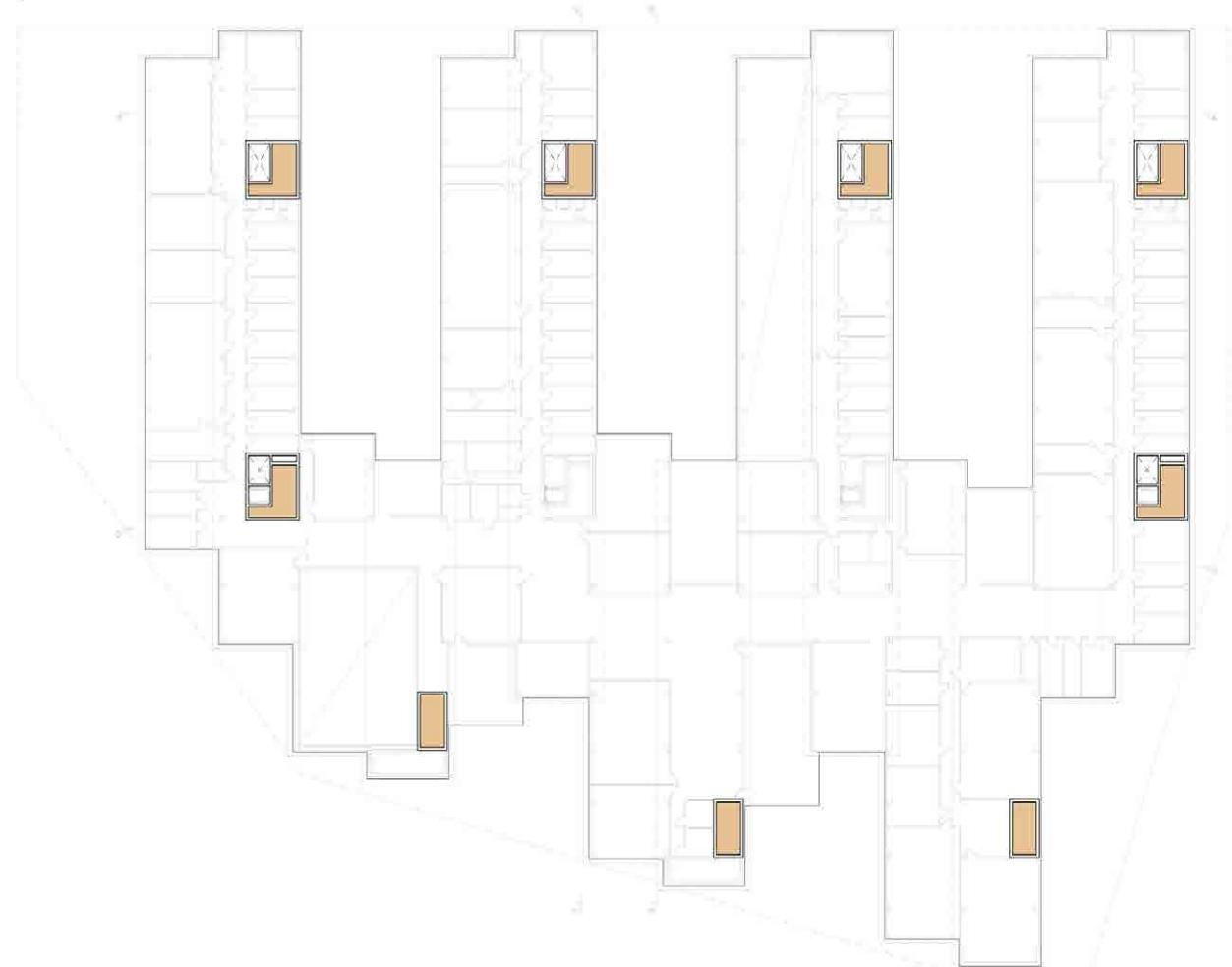
Shema lokacij požarnih stopnišč v tipični etaži | 1:500
