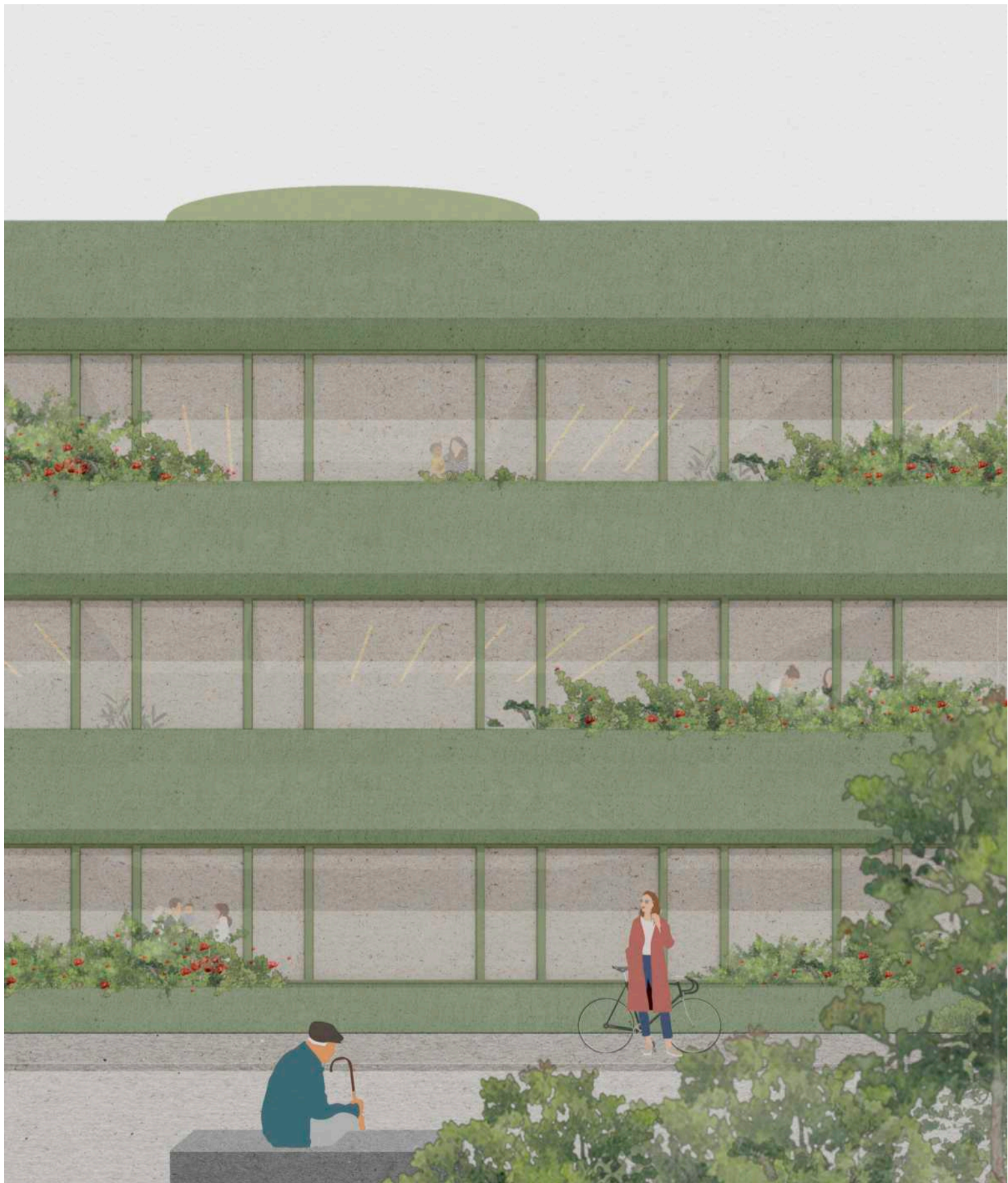
Zasnova južne fasade s pasivnim sistemom senčenja
