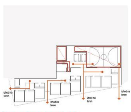
Shema požarne varnosti - klet
