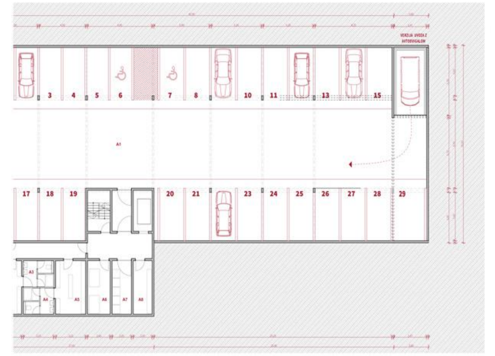
ALTERNATIVNI tloris kleti merilo 1:200 namesto rampe se namesti avtomobilsko dvigalo in s tem pridobi 4 dodatna parkirna mesta
