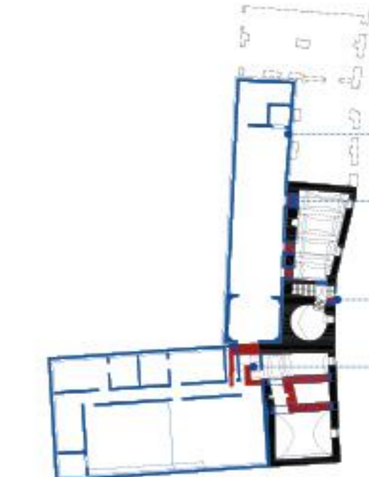
LEGENDA obstoječe rušitve novogradnja shema posegov m 1:500
