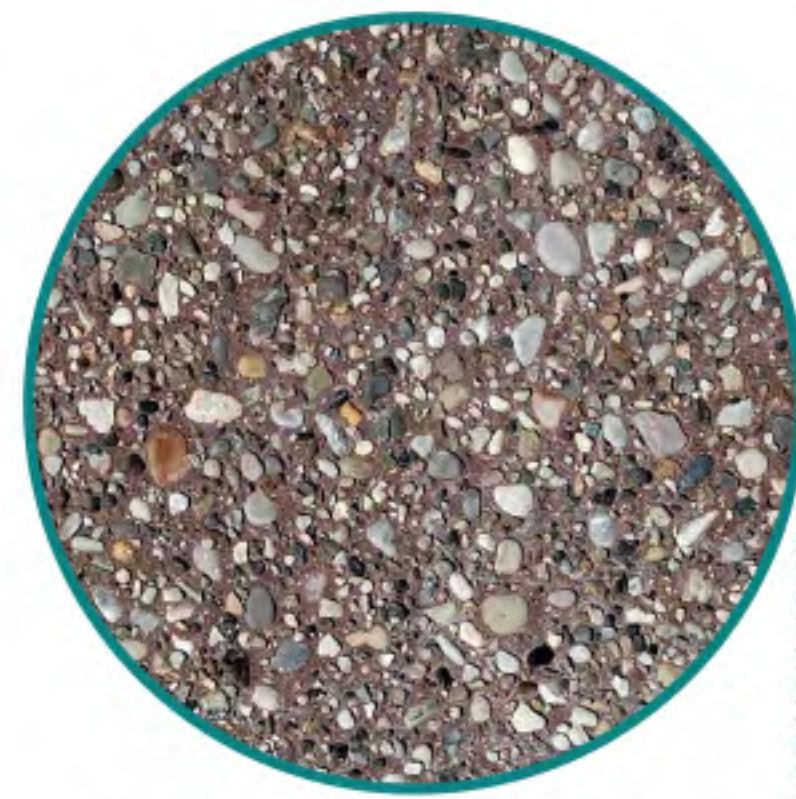
TLAKOVANJE PO PRINCIPU PRANEGA BETONA Z LOKALNEGA AGREGATA
