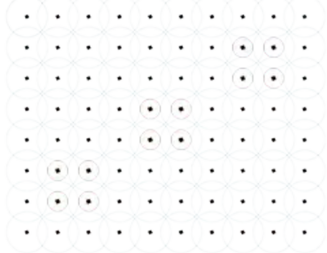
viskotalčni sistem (voda), višina hladne vodne megle 0,8 m
