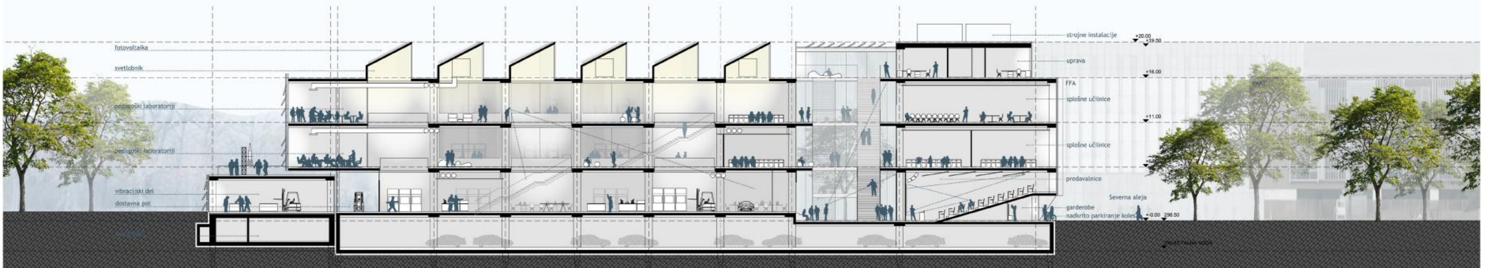
Prerez P3 skozi laboratorijsko halo, avlo in predavalnice v smeri sever - jug / M 1:250
