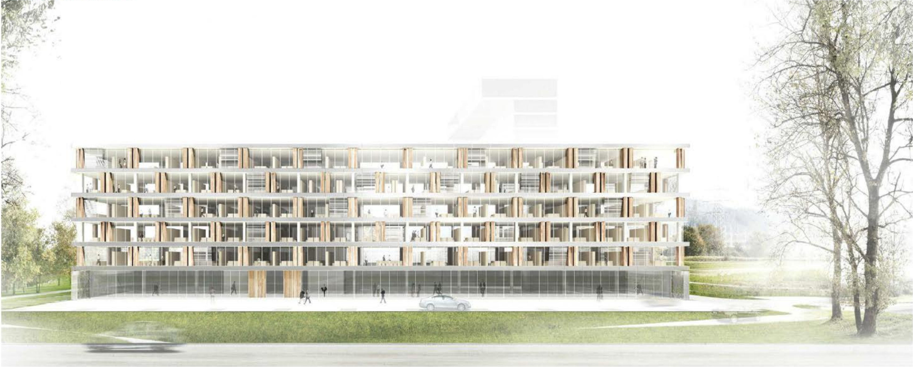
FASADA POSLOVNEGA DELA - GLAVNI NOSILEC PODOBE CELOTE - ZA SVOJE STRUKTURIRANJE UPORABLJA TEKTONSKI PRINCIP REPETICIJE ENEGA ELEMENTA, KI USTVARI 'GLOBINO' FASADE.
