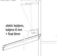
merilo 1:20 svetilnik z odbojnikom (Hess, Devio)
