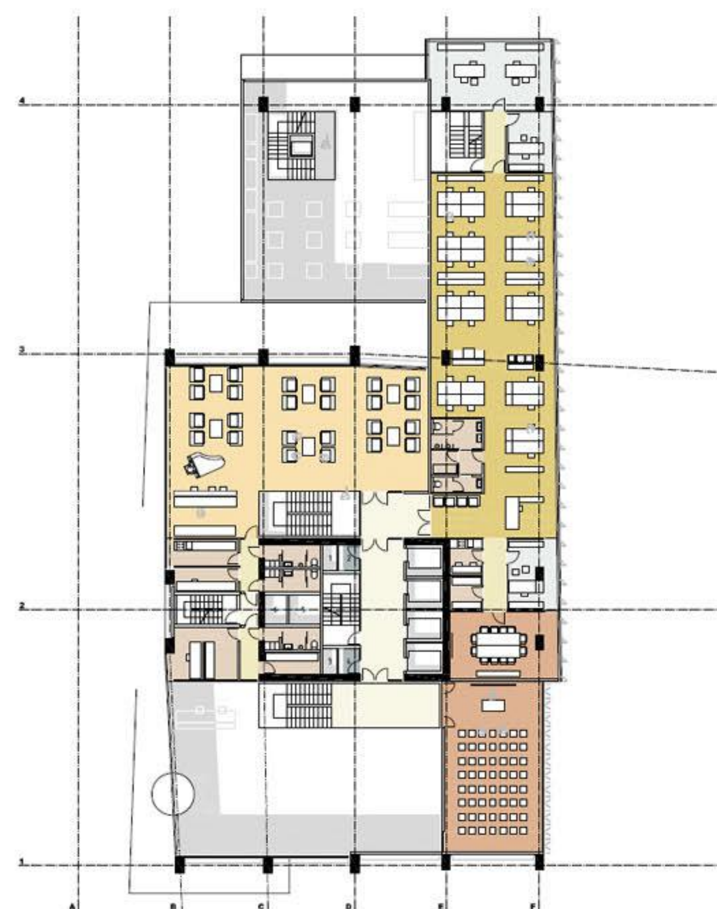
MEZANIN BTP = 884m 2 NTP = 794m 2 1. JAŠEK VODA, OGREVANJE, HLADNJE 2. ŠTEVO VODA, OGREVANJE, HLADNJE 3. JAŠEK ELEKTRIKA 4. ŠTEVO ELEKTRIKA 5. JAŠEK DOVODI DIMA IN TISLOTI IZ KLETI 6. JAŠEK PREHRAJNE PRTLJAJA, MEZANINA, 1. IN 2. ETAŽI
