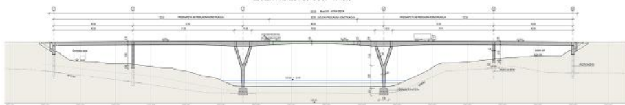
VZDOLJNI PREREZ MOSTU ZA PEŠCE IN KOLESARJE M 1:500
