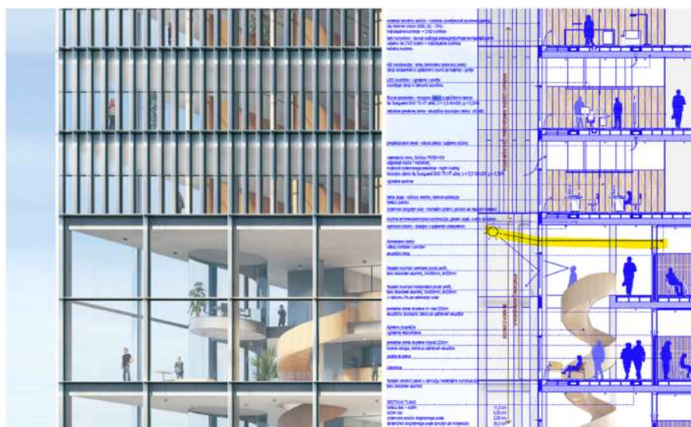
FASADA Z LITOREZKANIM STEKLOM V ZGORNJEM DELU TER ZASNOVA STEN Z ZASTEKLITVIJO NAD VIŠINO 2,0 M OMOGOČAJO NARAVNO OSVETLITEV V GLOBINO ETAŽ.
