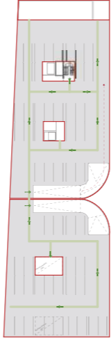
1. KLETNA ETAŽA Pozarna baza linije predstavlja svojo ločen požarni sektor. Komunikacijska linija je v prvih ločenih sektorjih - v garaži 2. Tabe so zgolj nakazane možne pozicije požarnih jeter.
