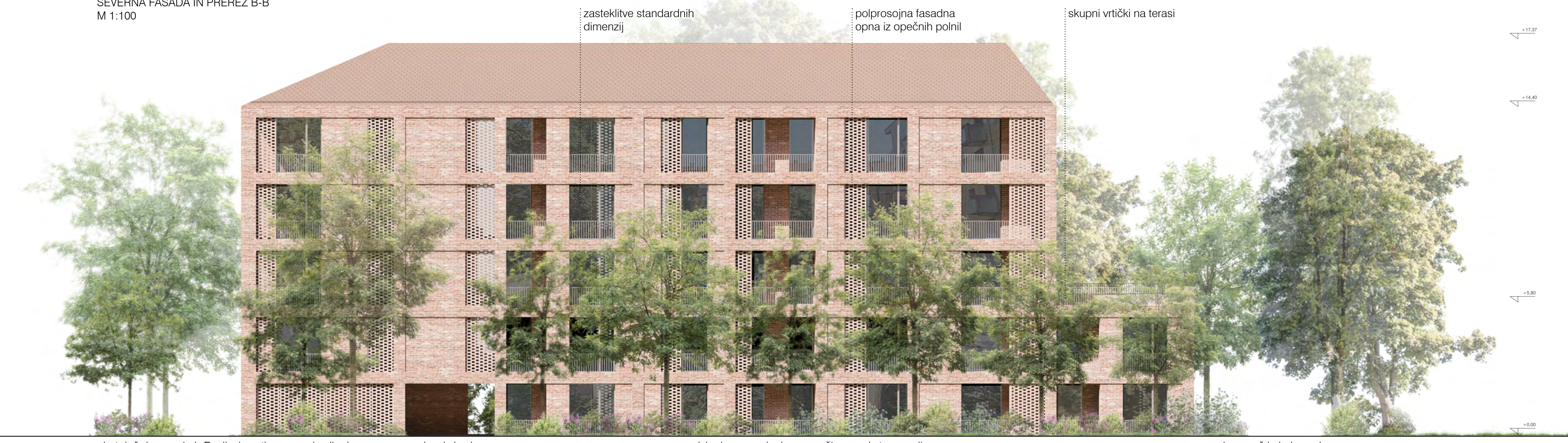
zasteklite standardnih dimenzij polprosojna fasadna opna iz opečnih polnil skupni vrtilki na terasi obstoječ drevored ob Resljevi cesti privzdignjena vhodna ploščad glavni vhod dvignjena zazelenjena površina pred stanovanji deluje kot bariera med javnim in zasebnim zelena peš in kolesarska povezava z drevoredom do Masarykove ceste
