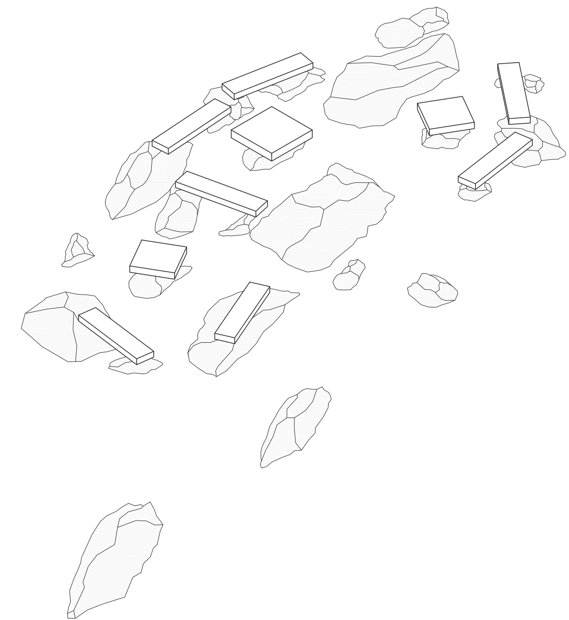
Aksonometrični prikaz principa umestitve klopi med naravno skalovje na vrhu Bovljeka (prostori za počitek, druženje in dogodke) lesene klopi se večinoma opirajo na obstoječe skale/kamne na lokaciji
