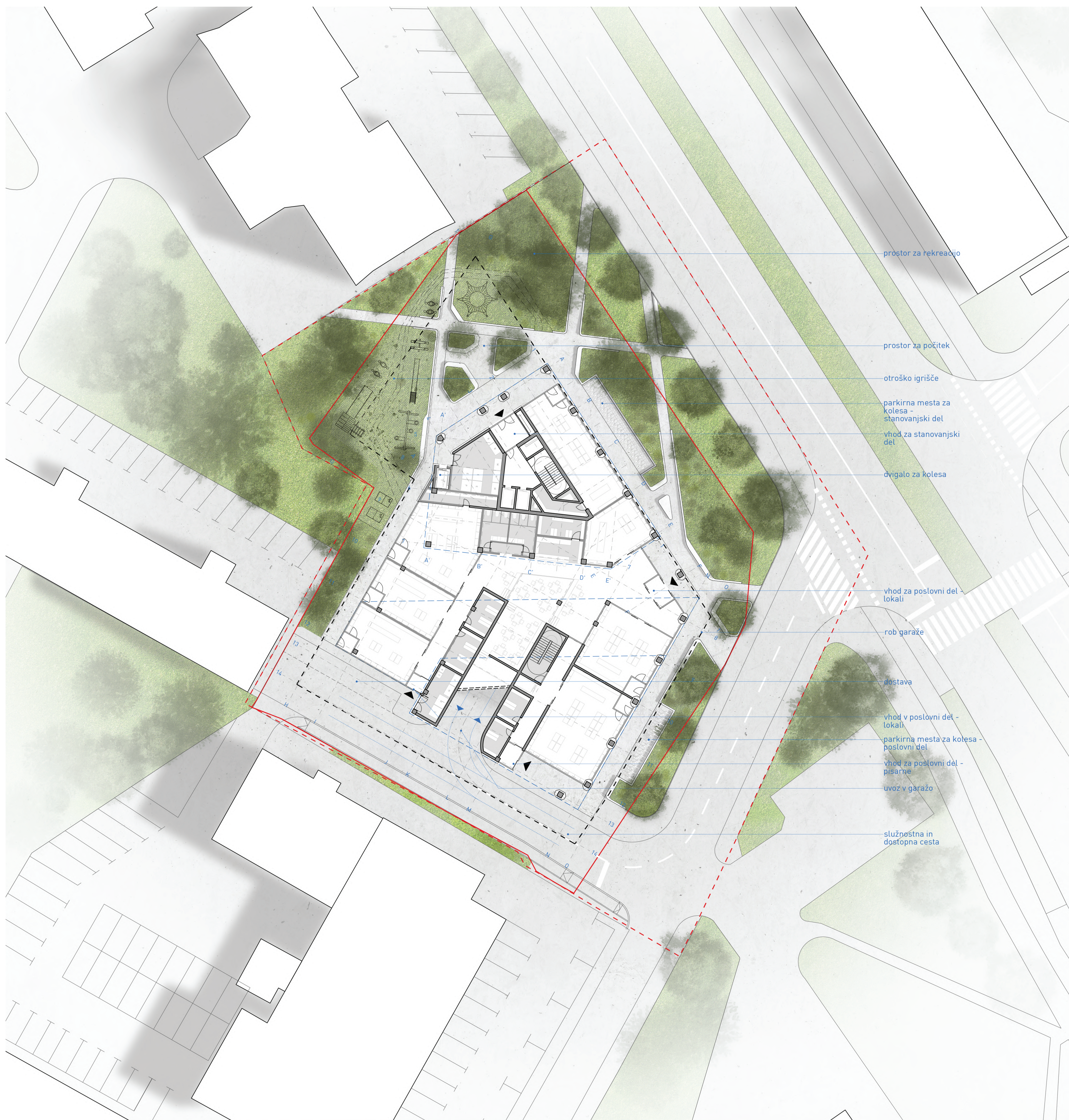
UREDITVENA SITUACIJA NATEČAJNEGA IN RAZŠIRJENEGA OBMOČJA S PRIKAZOM TLRISA PRITLIČJA, OBRISOM OBODA PODZEMNIH ETAŽ IN ZUNANJO UREDITVIJO 1:250
