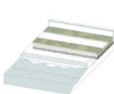
VZPOSTAVITEV SADILNEGA JARKA RASTNI PROSTOR ZA OBSTOJEČE IN NOVE PINJE TER ZELENI LOČILNI PAS. POVOZNI RASTI PROSTOR ('STOCKHOLM SISTEM').
