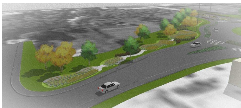
Slika 46: Ob novi cesti v Puli se uredijo deževni vrtovi, za odvajanje poplavne vode vir: T. Uzelac in K. Sošić
