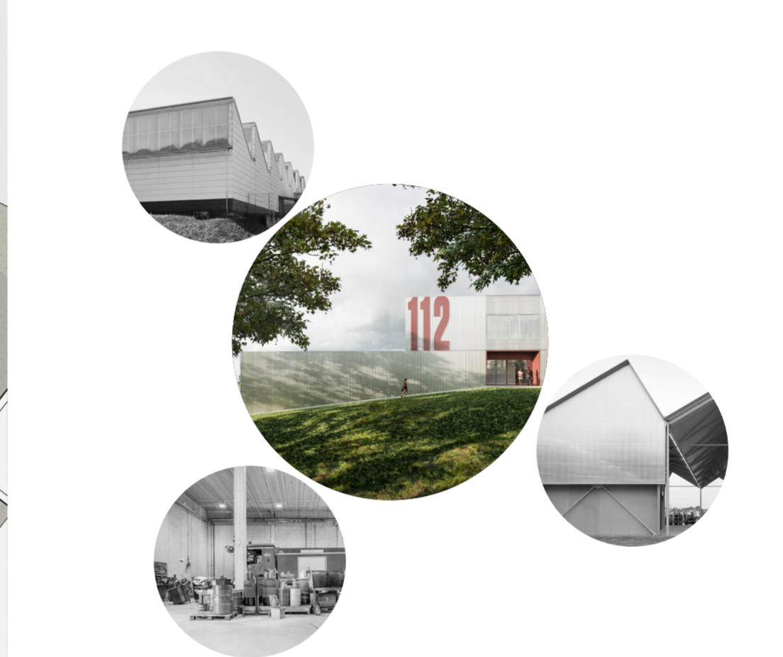
PREMIŠLJENO OBLIKOVANJE ARHITEKTURNEGA IZRAZA POJAVNOST NOVEGA CENTRA SUTILNO POVZEMA »ESTETIKO« INDUSTRIJSKIH HAL IN Z UPORABO MONTAŽNIH TER STROŠKOVNO UČINKOVITIH PREFABRICIRANIH FASADNIH PANELOV PRISPEVA K HITROSTI IN EKONOMIČNOSTI GRADNJE.
