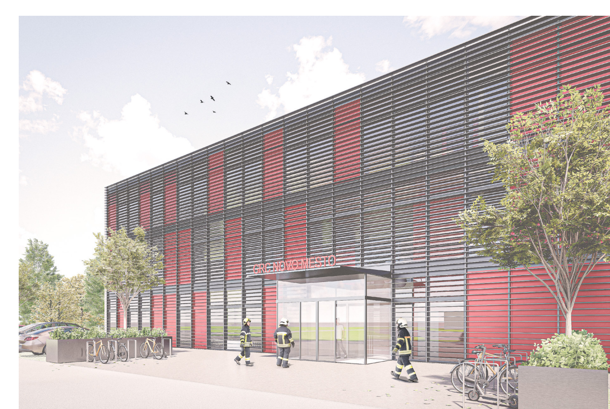
Vstopi v objekt so preko operativno-upravne lamele ter jasno izraženi z nadstrešnicami, ki so edini elementi, umaknjeni iz fasadne ravnine, poenotene s horizontalnimi bris soneli
