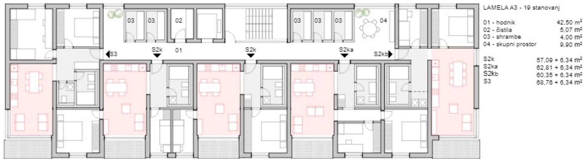
TLORIS TIPIČNEGA NADSTROPJA - lamela A3 M 1:200
