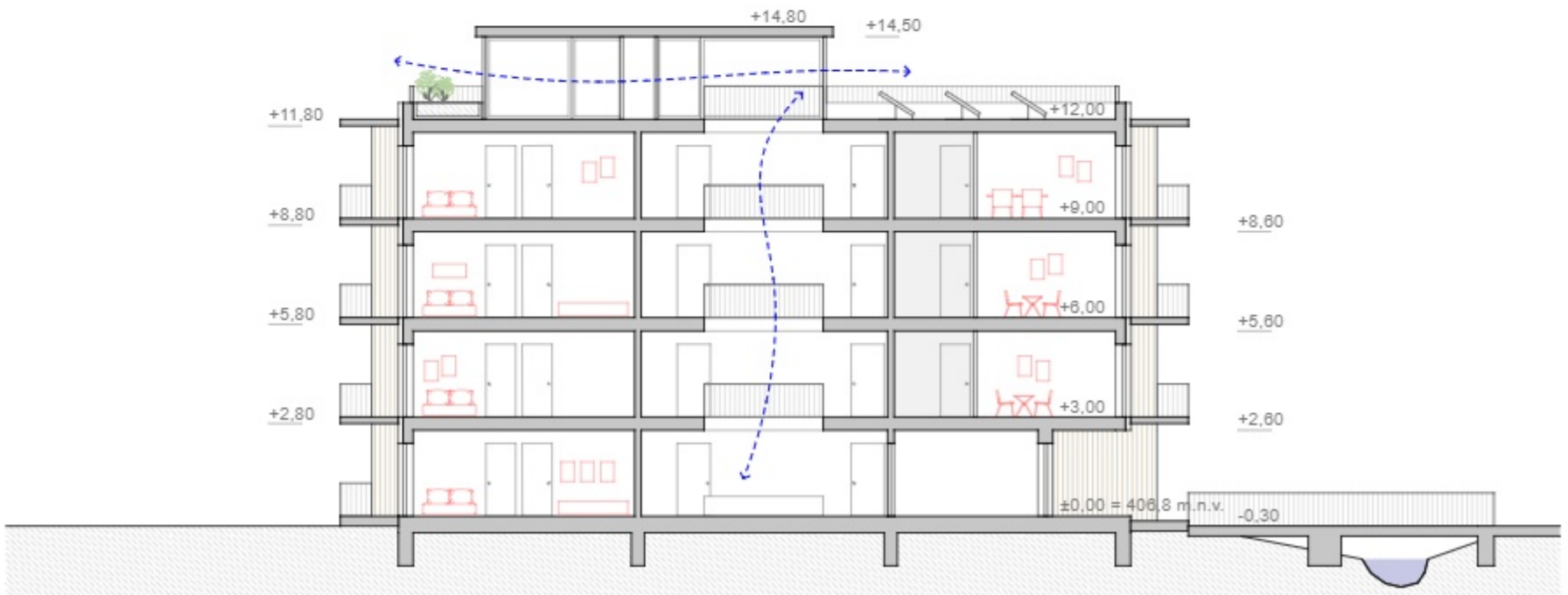
PREČNI PREREZ BLOKA B2 - prerez čez vodotok
