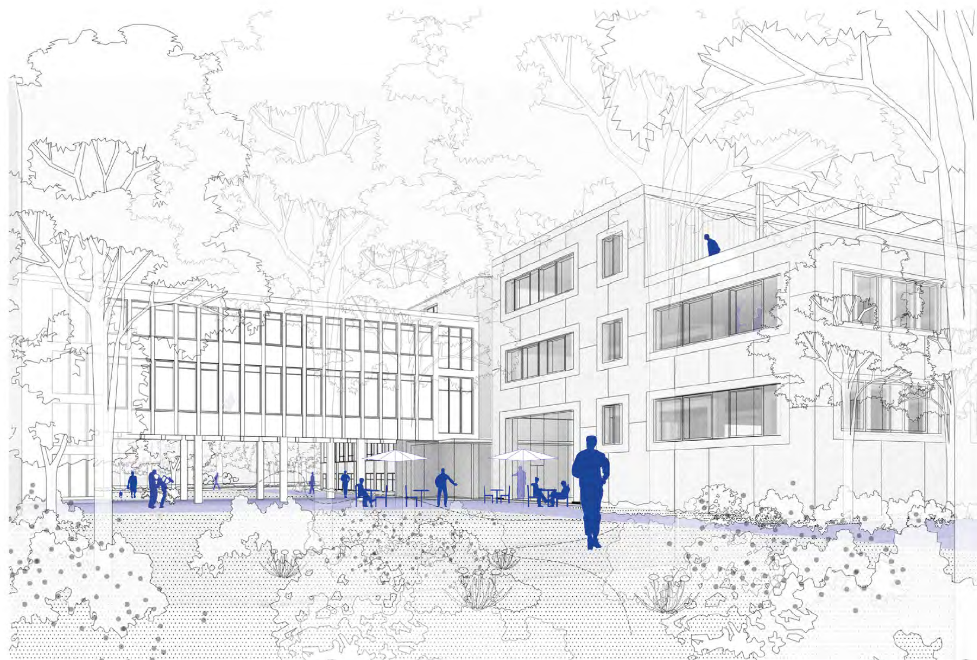
TRAKT LABORATORIJEV IMA FASADO IZ BETONSKIH PREFABRIKATOV Z VELIKIMI HORIZONTALNIMI OKNI, KJER SE FIKSNE ZASTEKLITVE KOMBINIRAJO S POLNIMI PRESLEDKI: Z LOPUTAMI ZA ZRAČENJE IN ZA PRIKLJUČEVANJE PREDELNIH STEN. OKNA IMAJO ŠIROKE KOVINSKE OKVIRE. OBJEKTA LABORATORIJEV IMA TRDEN, TEKTONSKI IZGLED. POLNA FASADA Z VELIKIMI HORIZONTALNIMI OKNI JE HOMMAGE HUMEKOVI FASADI NA JURČIČEVI.
