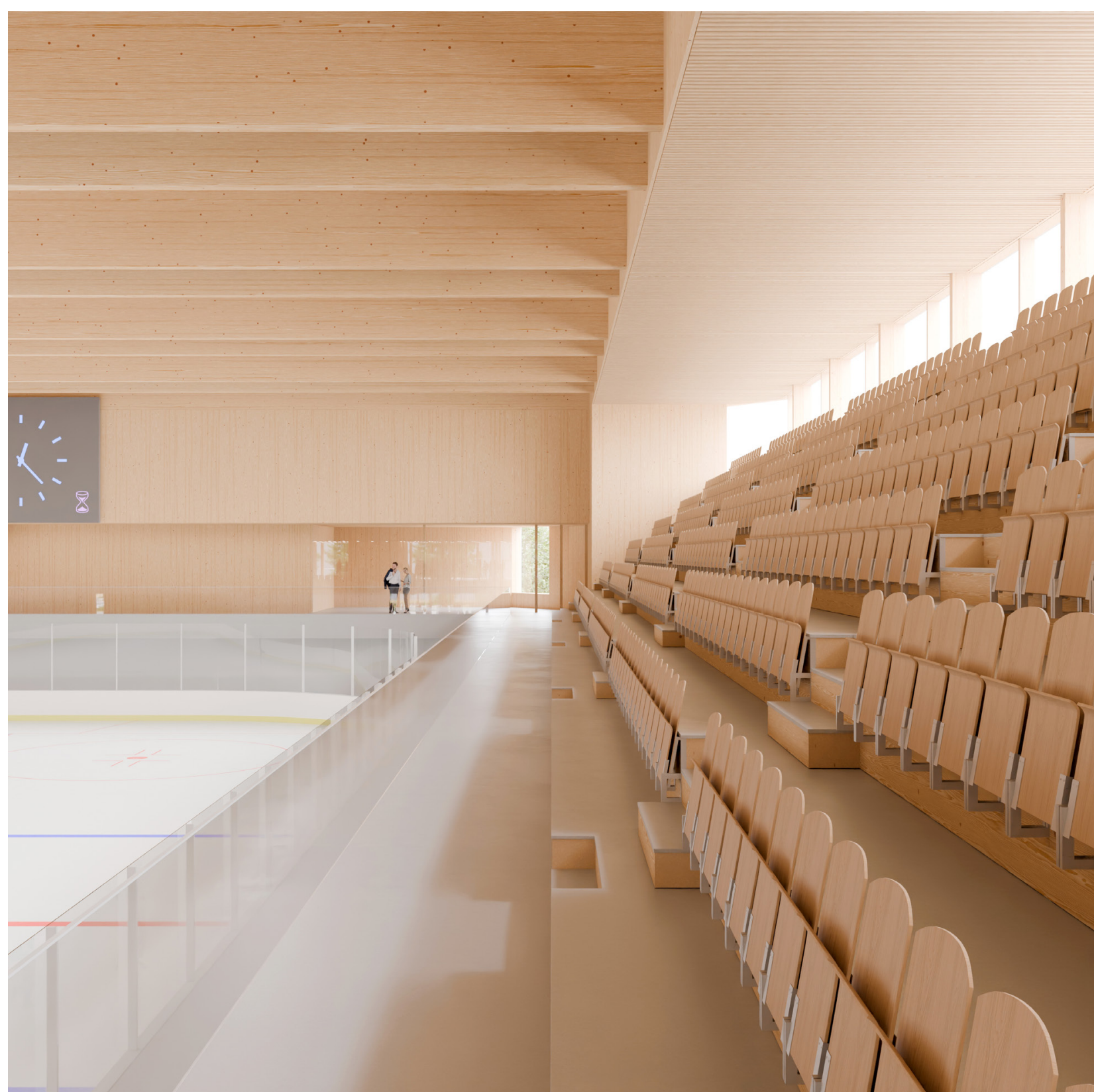
Pogled iz glavne tribune proti zahodu | Glavna tribuna je dvignjena v prvo nadstropje. Spodnji del tribune je teleskopsko zložitven, s čimer se lahko poveča prostor balkona za primer različnih prireditelj. Natančno odmerjene fasadne odprtine vnapaj notranjost dvorane z neposredno okolico in širšim prostorskim kontekstom.
